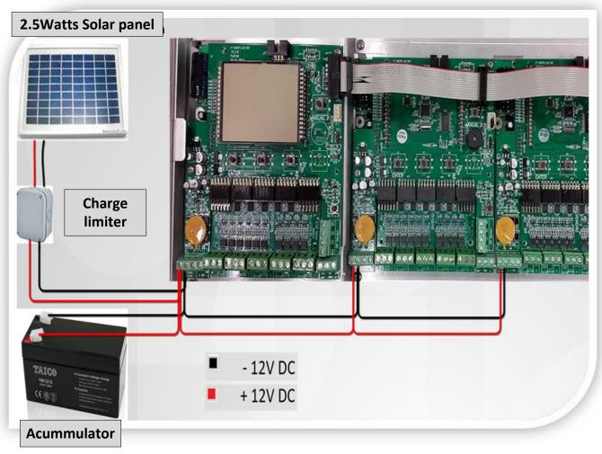
Filtron 20 30 DC: Energy wiring.
